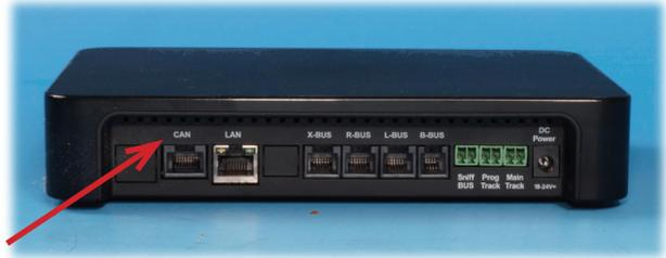
Möchte man eine größere Anzahl an CAN-Modulen an der Z21 betreiben, wird die Stromversorgung des Anschlusses irgendwann nicht mehr ausreichen. Hier gibt es dann zwei Lösungen: Zum einem den Z21 CAN HUB von Roco, mit dem eine zusätzliche Einspeisung in den Bus realisiert werden kann.
