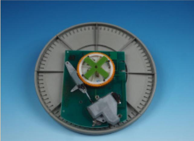
der auf den Antrieb, dabei muss man lediglich kontrollieren, ob der Magnet nun nicht an dem Gehäuse der Abdeckung scheuert. Dies sollte normalerweise nicht der Fall sein, aber eine Kontrolle ist besser.
