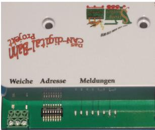
Die LEDs können aber auch beim Start oder im Betrieb verschiedene Fehlermeldungen anzeigen.
