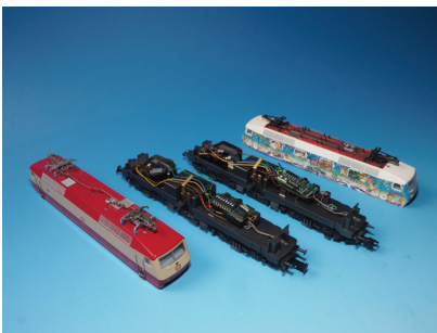
In der Baureihe 120 von Märklin lassen sich die Glühlampen durch die Beleuchtung ersetzen.
