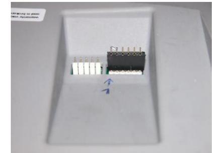
Dazu reicht es aus, einen 10k Ohm Widerstand zwischen die Pins 1 und 2 zu schalten. Dies kann man am leichtesten erreichen, indem man einen kleinen SMD-Widerstand der Baugröße 0805 zwischen zwei Pins einer Buchsenleiste lötet. Diese kann man dann leicht auf die Kontakte stecken.
