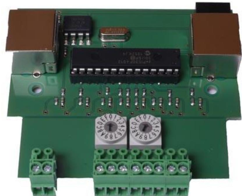
Dazu gehört das Einstellen der Moduladresse in dezimaler Schreibweise, eine Selbsttestfunktion am Modul, die auch vom PC aus aktivierbar ist, steckbare Schraubklemmen, komplette galvanische Trennung zum Systembus und Integration des Dioden-Tricks ohne zusätzlichen Verdrahtungsaufwand, sowie eine Serviceoberfläche am PC, mit der alle GleisReporter deLuxe konfiguriert und ausgelesen werden können, was, wenn zwei Schnittstellen im System-Bus vorhanden sind, auch während des Betriebes möglich ist!
