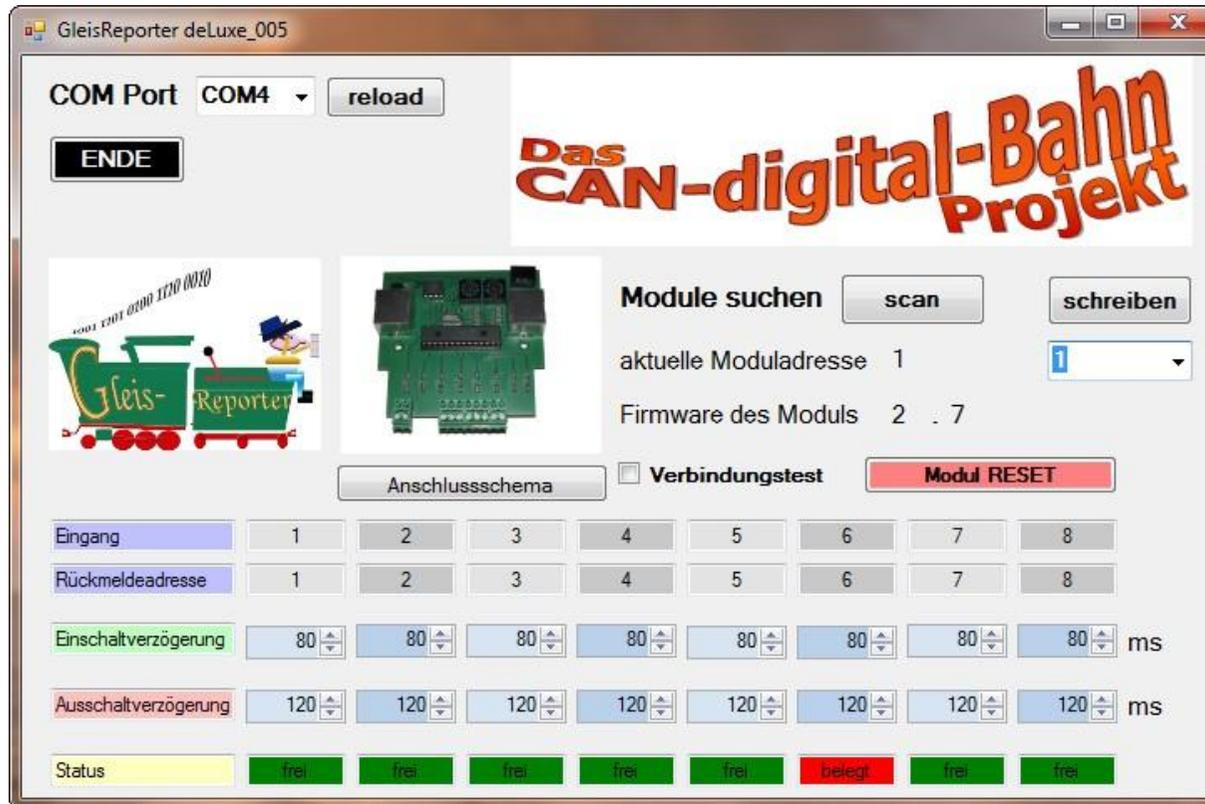
Als ersten Test kann man nun einmal den Selbsttest (Verbindungstest) starten, es sollte nun eine Besetztmeldung über die Statusanzeige wandern. Dieser Test bleibt solange eingeschaltet, bis der Haken dazu wieder entfernt wird. So kann man auch nacheinander mehrere Module in diesen Modus versetzen und sich im Steuerungsprogramm anschauen, ob die Meldungen dort sichtbar sind.
