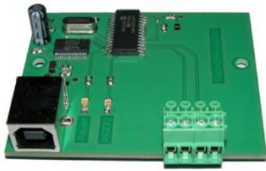
Abbildung 3 Aufbauplatine des TachoMessers in der Version USB ohne Gehäuse 16 ;
