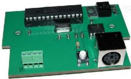
Abbildung 4 Aufbau der Platine für den TachoMesser in der Version CAN ohne Gehäuse 17 ;
